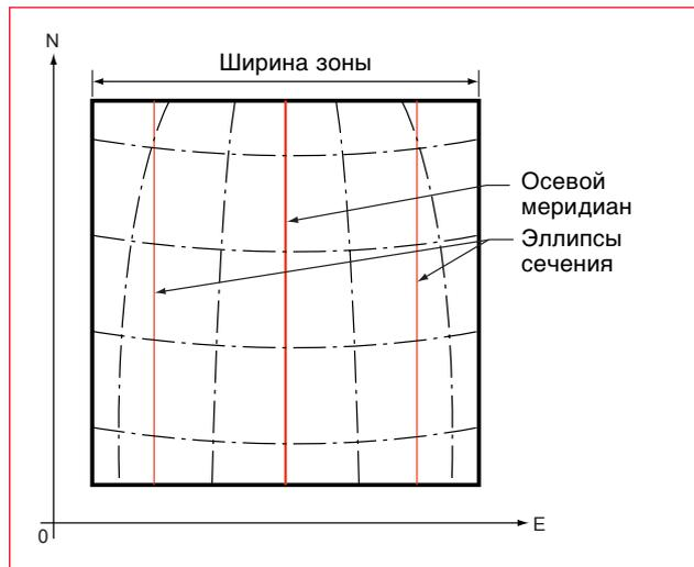
**Параметры поперечной проекции Меркатора.**
